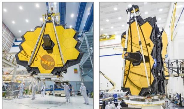
Figura 4. Lo specchio primario a celle esagonali aperto (a sinistra) e piegato (a destra). È visibile anche il secondario supportato da una struttura estensibile.
