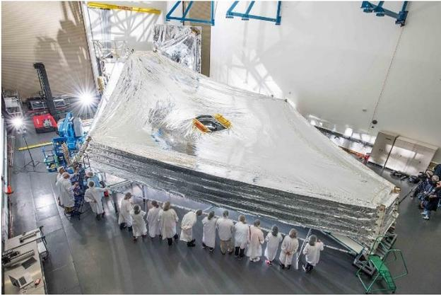
Figura 3. La protezione termica del JWST formata da 5 strati di una membrana speciale.
