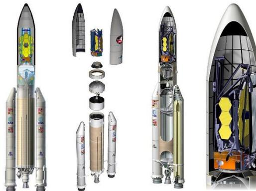
Figura 1. Il vettore Ariane 5 e l'ogiva contenente il JWST.
