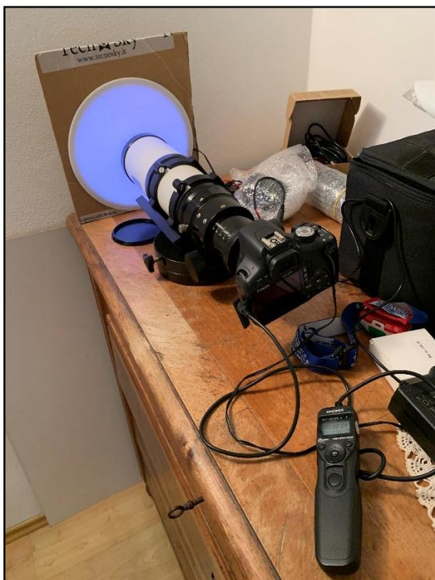
Figura 5. Flat Box davanti alla mia attrezzatura, col comando remoto per programmare la lunghezza delle foto.
