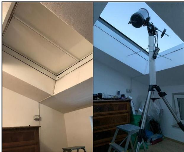
Figura 2. Il “finto tetto” dall’interno; montatura EQ 5 con due mezza colonne di prolunga e due tiranti con telescopio C8.
