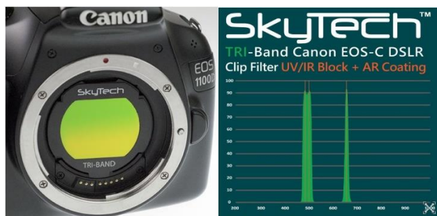
Figura 1. un unico filtro che fa passare solo ossigeno O III e idrogeno H-alfa e H-beta semplicemente appoggiato nella macchina fotografica e le tre bande che possono passare.
