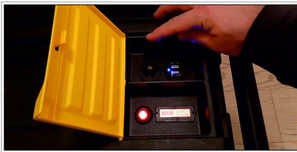
Foto 2 - Interruttore ON/OFF, presa accendisigari a 12 V, due prese USB a 5 V, e indicatore di carica a LED rosso.
