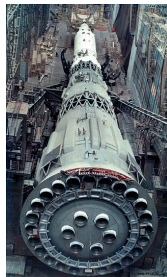
Figura 8. Il razzo N1 veniva assemblato orizzontalmente. Si notino i 30 motori del primo stadio.
